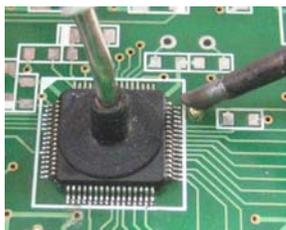
Этап 1 – на предварительно смоченные флюсом контактные площадки установите как можно точнее корпус микросхемы и припаяйте ее один крайний вывод к заранее облуженной (Шаг 1 - с обычным прутковым припоем) контактной площадке.
