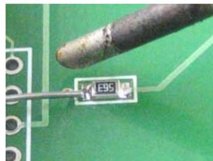
Пайку таких SMD компонентов, как микросхемы в корпусах SOIC, TQFP, и др. можно произвести в три этапа, используя флюс и прутковый припой диаметром 0,5 мм. Используйте жало паяльника для пайки волной.
