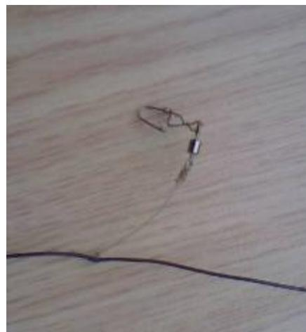
Повторю, что эта антенна очень чувствительна к земле. В классическом варианте подстраивал её по месту подматыванием (отматыванием) плеча на плоскую катушку. В многодиапазонном варианте неплохие результаты получил, включив между антенной и трансивером подстроечный конденсатор на 300 пикофарад.
