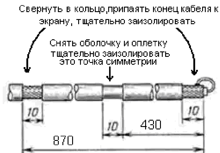
Рис. 5. Схема разделки кабеля при изготовлении петли связи.
