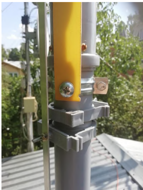
Рис. 2. Детали крепления "двоечного" (пассивного) элемента к пластиковой трубе, в которую помещена основная часть антенны.
