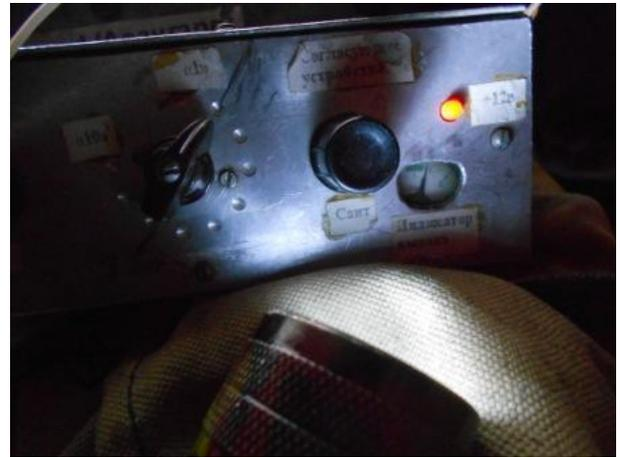
Передатчиком будет работать трансивер- супергетеродин на 14060, с согласующим устройством, 3 ватта на выходе. Ножом замыкаю гнёзда CW ключа. Настраиваю... «Окно» залеплено снегом и света маловато!
