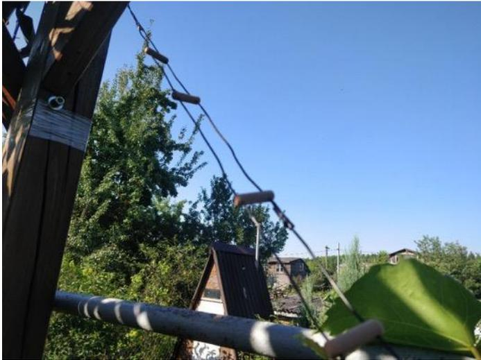
Для того, чтобы согласовать рамку на более высокочастотных диапазонах, использовал двухпроводную линию, сделанную из продолжения полотна антенны, а в качестве распорок деревянные шканды.
