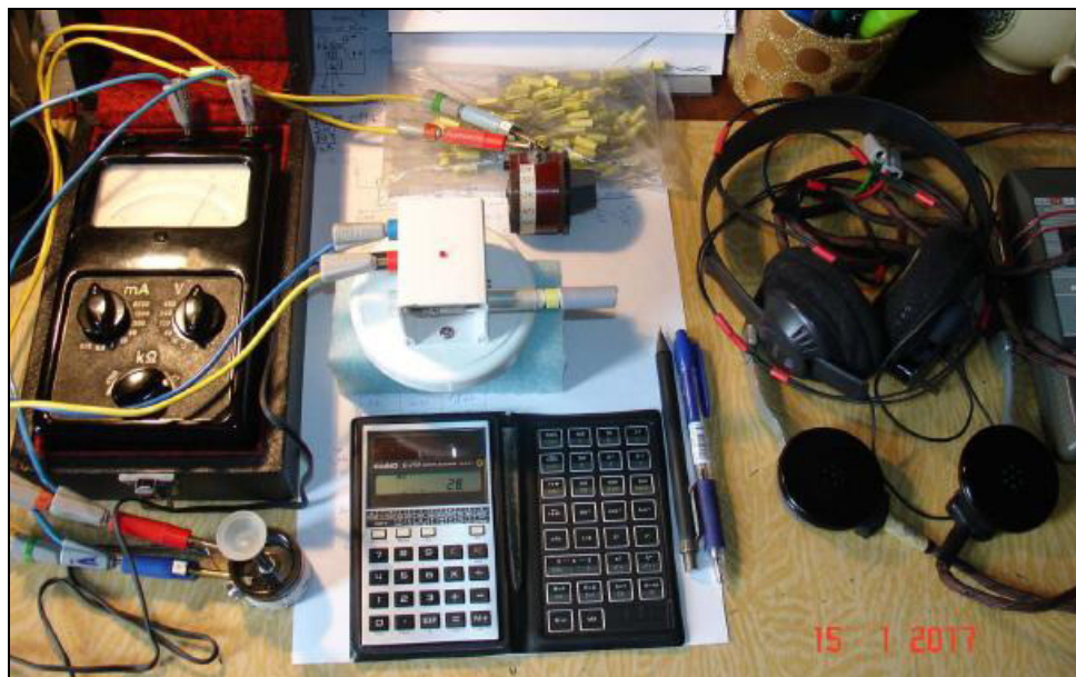
Měření ss výkonu na zátěži – na výstupu detektoru zatíženého činným odporem (drátovým potenciometrem s max. hodnotou 4000 \Omega ). Z naměřených hodnot napětí a činného odporu je spočítán ss výkon (mW) a sestrojena zatěžovací křivka.
