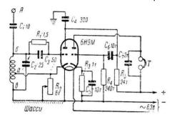
с помощью подключенного к контуру переменного резистора. Надо сказать, что эта схема удачна во многих отношениях, она технологична, не содержит дефицитных переменных конденсаторов, очень слабо влияет на частоту собственных колебаний контура, не имеет гистерезиса, паразитных резонансов, обеспечивает плавность подхода к режиму генерации. Элемент регулировки не находится под высоким напряжением. Довольно странно, что она не получила широкого распространения, подобно другим
